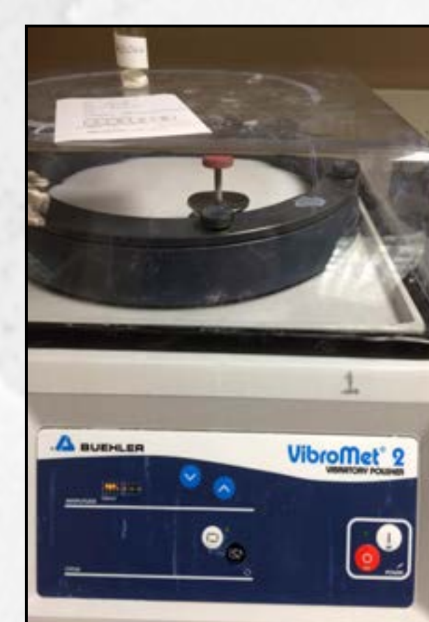
Final polish using the Vibro Met 2
